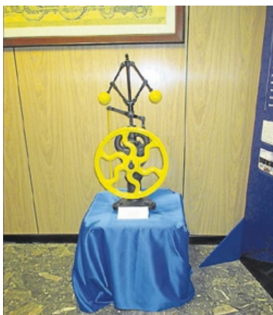
Una reliquia. Limitador de velocidad de un ascensor.
