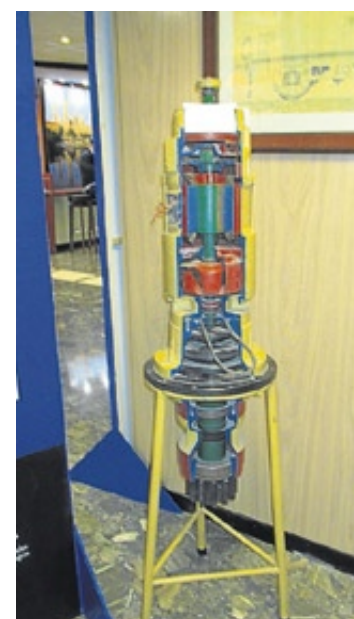
Grúa torre. Mecanismo de giro.
